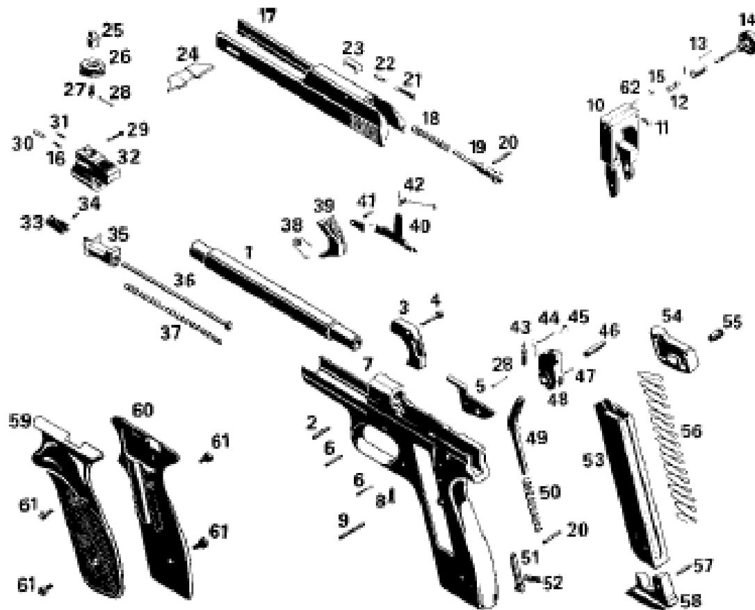
Рисунок 1 – Сборочные единицы и детали пистолета
